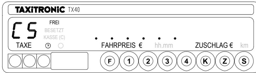
Drücken Sie die **1** Taste. Der erste Dezimalpunkt im Fahrpreis-Display beginnt zu blinken und das Löschen der Tagesspeicher kann erfolgen.
