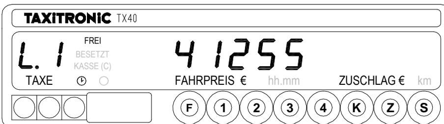
Beim nachfolgenden Drücken der Taste **K** oder nach einigen Sekunden werden die Daten des Infoblock Nr.2 angezeigt.
