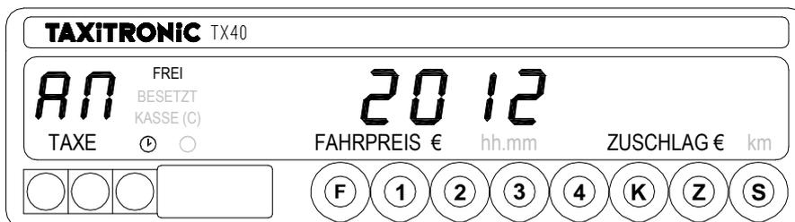
Beim Drücken der **F** Taste oder nach einigen Sekunden schaltet der Taxameter in Frei um
