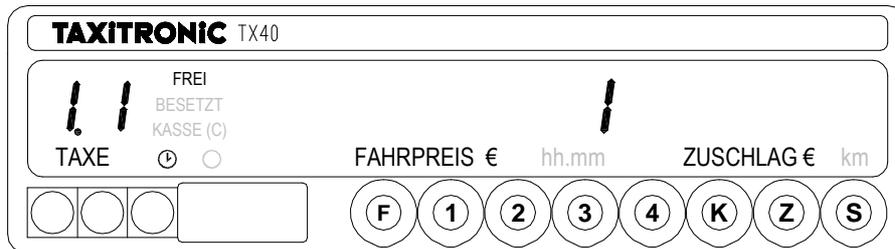
Beim nachfolgenden Drücken der **K** Taste oder nach einigen Sekunden werden die Daten des Infoblock Nr.3. angezeigt. Es handelt sich um die Tarifparameter von Taxstufe 1:
