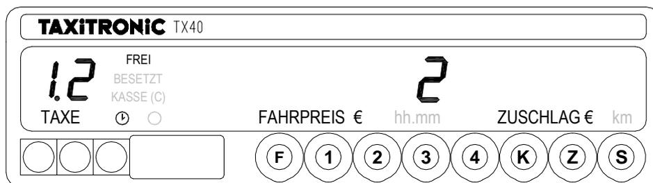
Nachdem alle Parameter der unterschiedlichen Taxstufen angezeigt worden sind, schaltet der Taxameter automatisch in Frei um.
